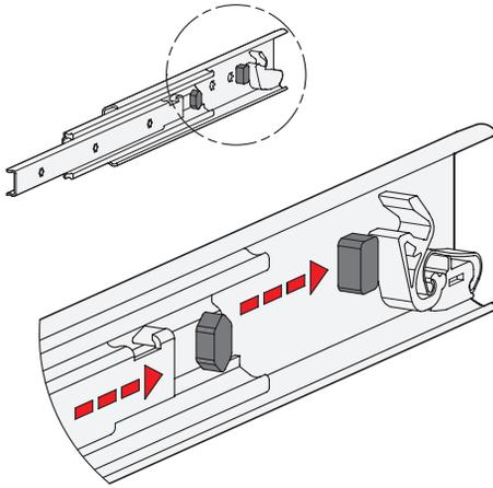
Die Stoppgummi der Form B dämpfen das Anschlagen der Schiene in der jeweiligen Endstellung. Dadurch wird die Geräuschentwicklung minimiert und die Lebensdauer erhöht. Teils versteckt, teils sichtbar an den Schienen angebracht sind sie bzgl. Gestalt, Werkstoff und Härte auf die jeweiligen Anforderungen abgestimmt.
