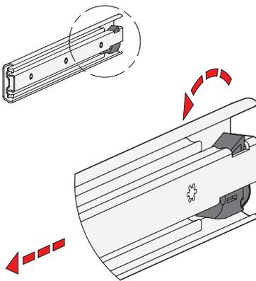
Teleskopschienen GN 1422 sind mit einem integrierten Selbsteinzug versehen, wodurch der Bedienkomfort beim Schließen von Auszügen wesentlich verbessert wird.
