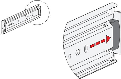
Die Stoppgummi der Form B dämpfen das Anschlagen der Schiene in der jeweiligen Endstellung. Dadurch wird die Geräuschentwicklung minimiert und die Lebensdauer erhöht. Teils versteckt, teils sichtbar an den Schienen angebracht sind sie bzgl. Gestalt, Werkstoff und Härte auf die jeweiligen Anforderungen abgestimmt.
