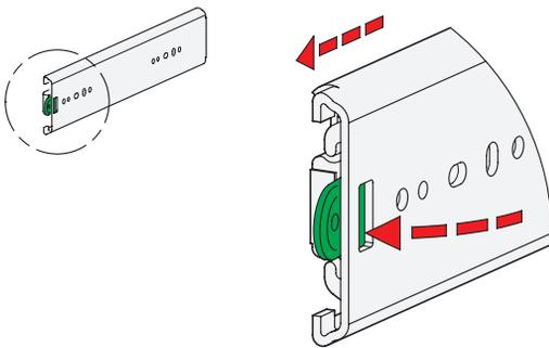
Die Form M wird bei Anwendungen eingesetzt, bei denen die Schiene in der hinteren Endstellung verriegelt sein soll. Selbstständiges Ausfahren z. B. durch Schräglage wird so verhindert. Treten in der Verriegelungsposition größere Belastungen in Auszugsrichtung auf, sollten diese durch externe Verriegelungselemente aufgenommen werden.
