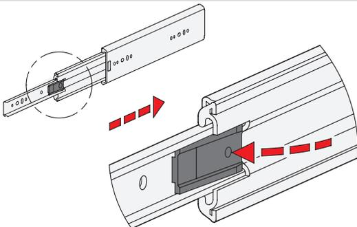
Die Form K wird dann eingesetzt, wenn der Auszug für eine gewisse Zeit in der vorderen Endlage verbleiben soll. So können z. B. Wartungsarbeiten bei geöffnetem Auszug durchgeführt werden. Treten in der Verriegelungsposition größere Belastungen auf, sollten diese durch externe Verriegelungselemente vorgesehen werden.
