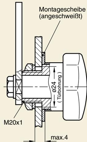
Montagescheibe kann entfallen, wenn die Bohrung zur Aufnahme der Verriegelung direkt eingearbeitet wird.
