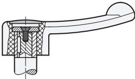
Schaltgriffe GN 623 / GN 623.5 befestigt mit Nabennut / Passfeder unter Verwendung von Vorlegescheiben GN 184 / GN 184.5 → Seite XYZ.
