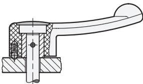
Schaltgriffe GN 623 / GN 623.5 mit Kugelraste zur Indexierung des Schaltwinkels, befestigt mit Querstift. Der Querstift ist unter einem Winkel von 45° zur Schaltachse anzubringen. Kugel und Druckfeder gehören nicht zum Lieferumfang in der Standardausführung. Weitere Informationen hierzu auf Anfrage.
