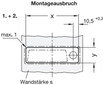
1) Die Ausnehmung in der Tür zum Einbau der Verriegelung mit Griffschale muss gemäß nebenstehender Skizze angefertigt werden.
