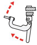
Dann den Spannbügel und den Spannhebel des Bügelspanners nach oben bewegen.
