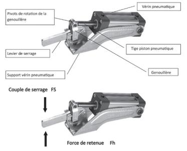
La force qu'un outillage est en mesure d'exprimer durant la fermeture est définie comme force de serrage [FS] et la force que l'outil, en position fermée, est capable de supporter sans subir de déformations permanentes est appelée force de retenue [Fh].
